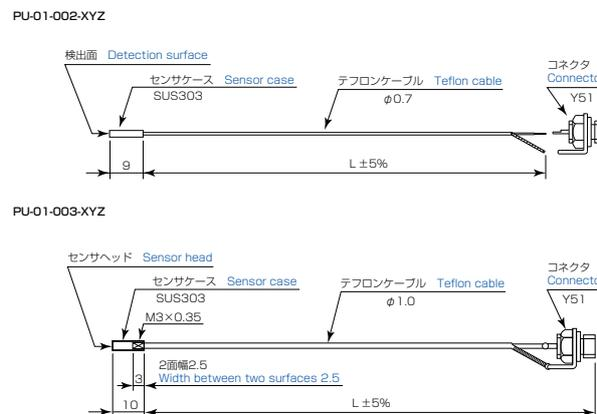
※型式の末尾3桁、XYZはケーブルの長さを表す。X、Yは、ケーブル長さの有効数2桁、Zは乗数を表す(単位mm)例:標準のケーブル長さ400mmは401、1000mmは102
