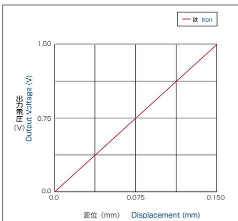
ターゲット材質による変化(校正後)
