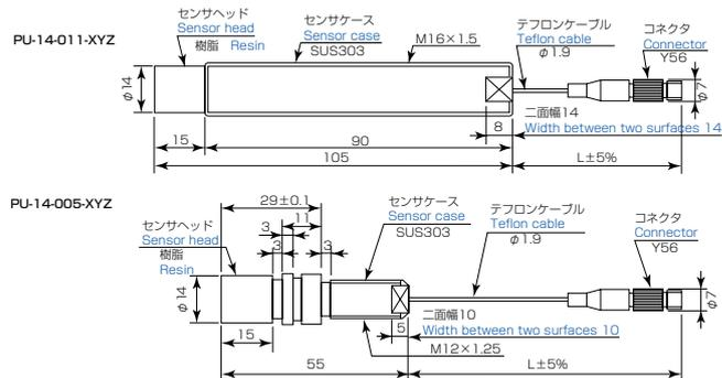
※型式の末尾3桁、XYZはケーブルの長さを表す。X、Yは、ケーブル長さの有効数2桁、Zは乗数を表す(単位mm)例:標準のケーブル長さ400mmは401、1000mmは102
