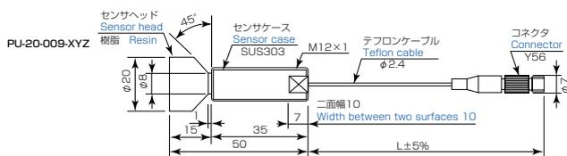
※型式の末尾3桁、XYZはケーブルの長さを表す。X、Yは、ケーブル長さの有効数2桁、Zは乗数を表す(単位mm)例:標準のケーブル長さ400mmは401、1000mmは102
