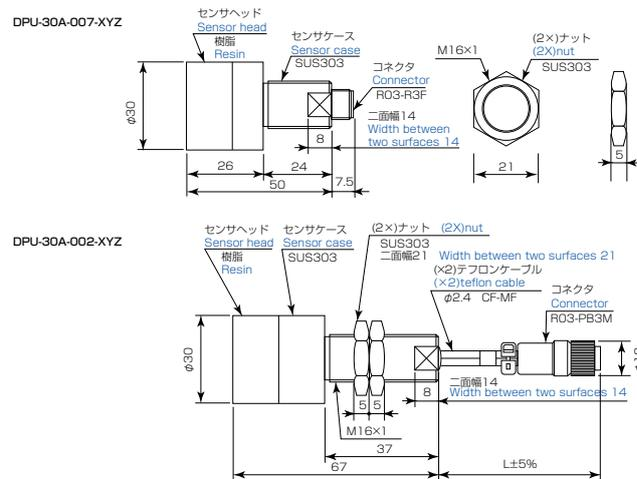
※型式の末尾3桁、XYZはケーブルの長さを表す。X、Yは、ケーブル長さの有効数2桁、Zは乗数を表す(単位mm)例:標準のケーブル長さ400mmは401、1000mmは102
